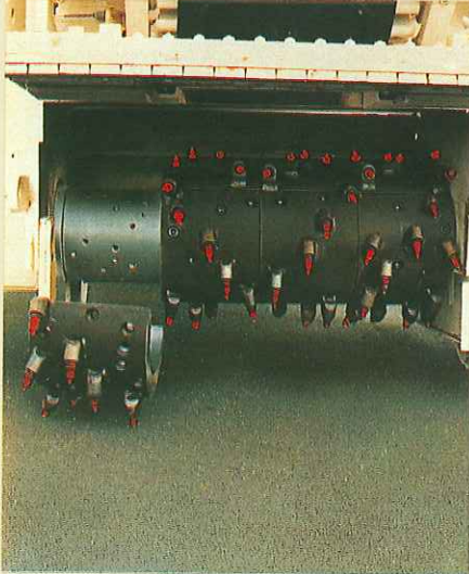
250mmセグメントを取り外したところ
