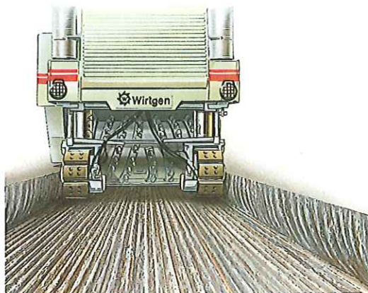
簡単にワン・マンによる運転：運転席から切削深さを調整
