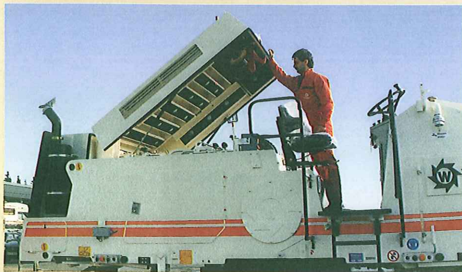
エンジン・フードは片手でロックを外し、開閉することができます
