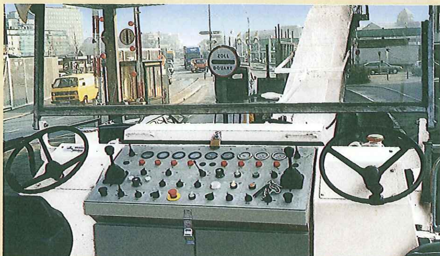
運転席；主要なコントロール機器は左右両端に位置しています
