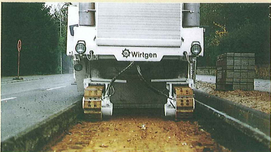
疲労した舗装帯をワンパスで完全に除去します
