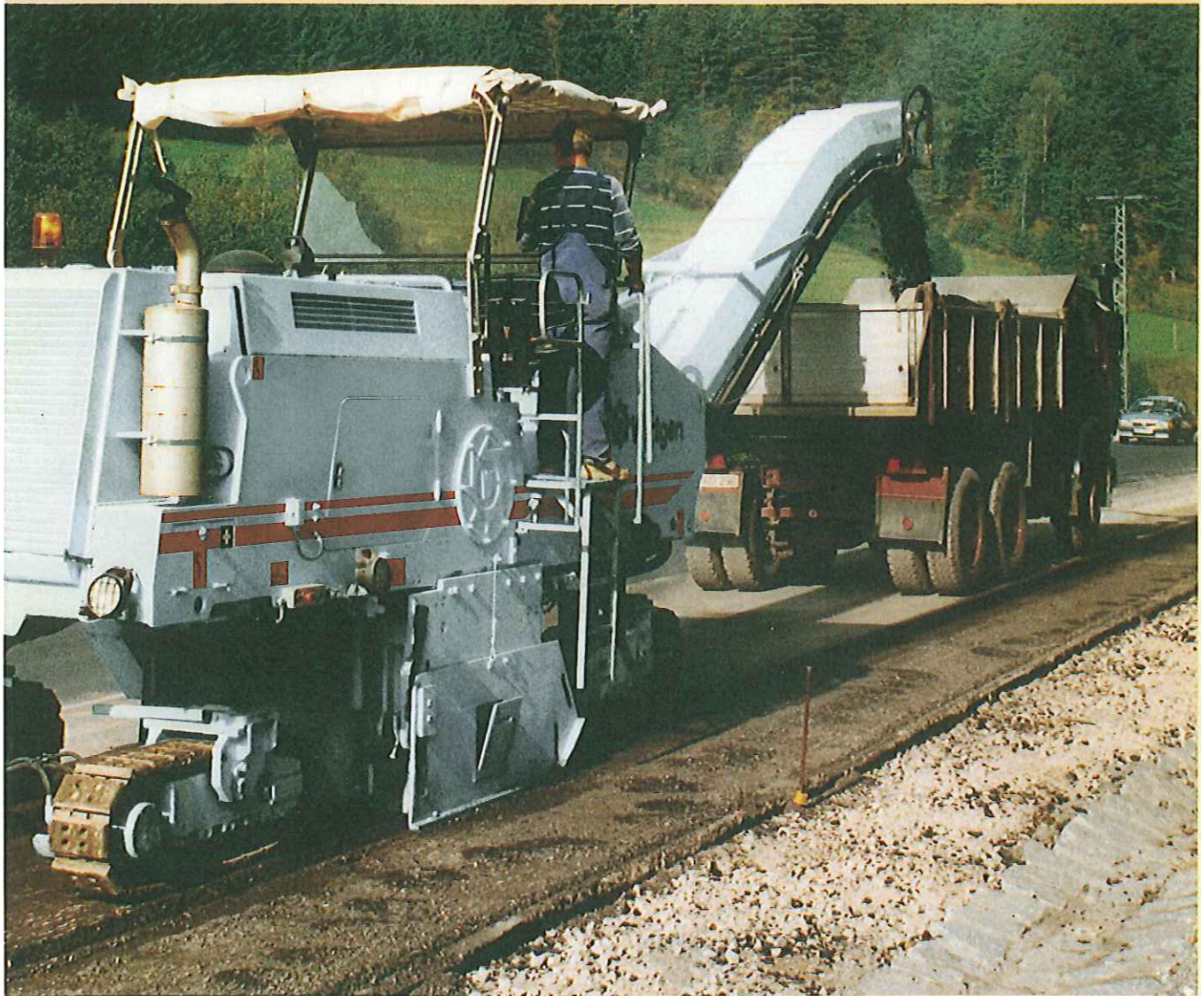
両側の切削エッジと同時に排出コンベアや積み込み中のダンプが見渡せます
