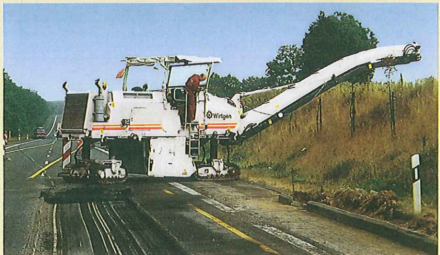
4輪(クローラー)ステアリングは狭い現場において高い機動性を発揮します
