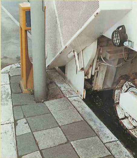
左右両サイドのフラッシュ・カット。例えば縁石等、障害物があっても容易に切削を行います。
