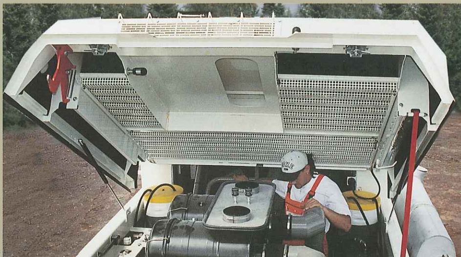
大型の防音装置付きのエンジン・フードを装着しているため、サービス作業も快適な作業ポジションで行えます。
