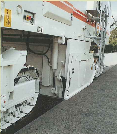
縁までギリギリに舗装を切削できるため、時間と費用が節約されます。
