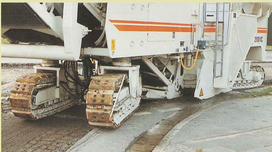
2100DCの優れた機動力と操作性は、4輪ステアリング方式によって実現されています。
