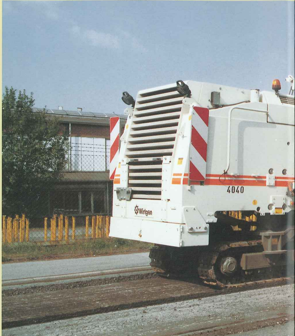
この切削機は電子制御式レベルコントロール・システムを装備しています。このシステムは、機械の左右両サイドに取付けられており、正確に保持され、数レーンの切削をする場合でも、水平でクリーンな切削面を作り出します。
