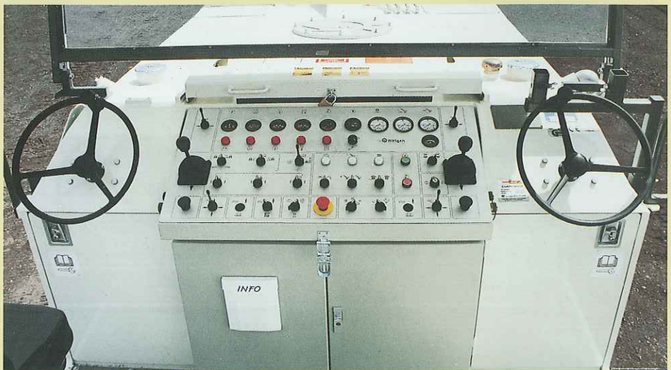
左右両側に整然と配置されたコントロール・パネルを持つオペレーター・スタンドが設置されているため、作業現場のどのような状況下でも、オペレーターは容易に制御装置類に手をのぼすことが出来ます。
