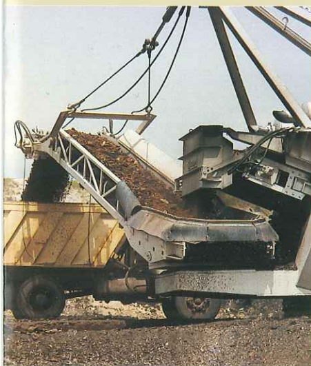
積み込み用コンベヤーは左右に転回することができる
