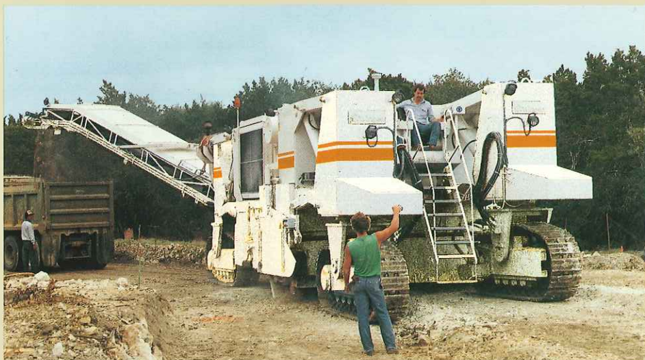
3500SM. 切削、断面整形及び積込みを一連の作業で行ないます。
