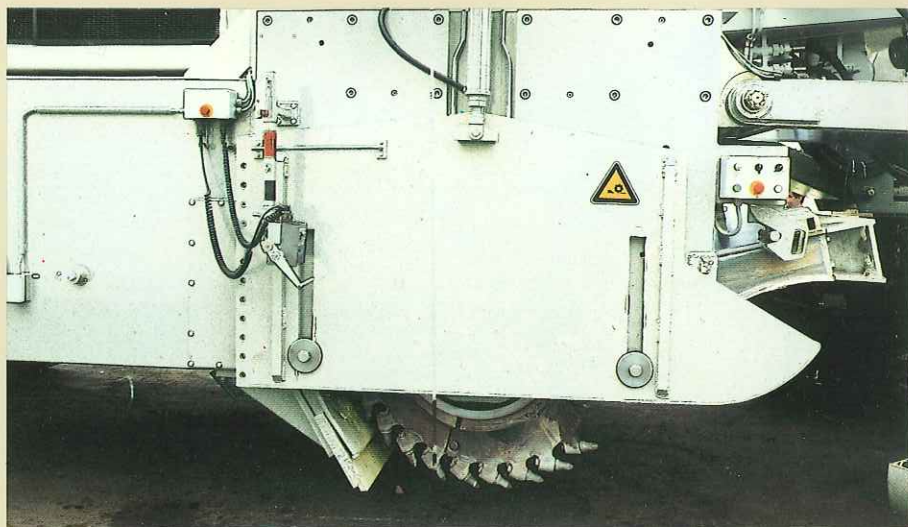
ドラムと側板の間隔がせまいので壁や障害物に接して切削ができます。 そしてスクレーパーは通行可能なきれいな面をつくれます
